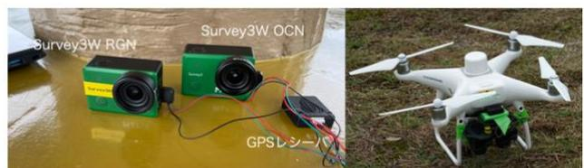
第2図 使用したマルチスペクトルカメラ（左）とカメラをドローンに搭載した画像（右）．
