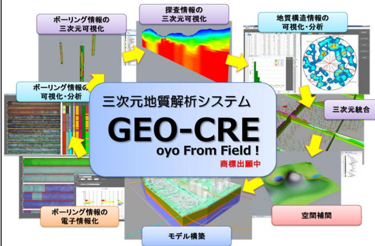
GEO-CRE (ジオクリ) は、地質踏査データや高品質ボーリングデータ、物理探査データ、地形データ等を速やかに見える化し、リアルタイムで現実的感覚のある三次元地質モデリングを可能とします
